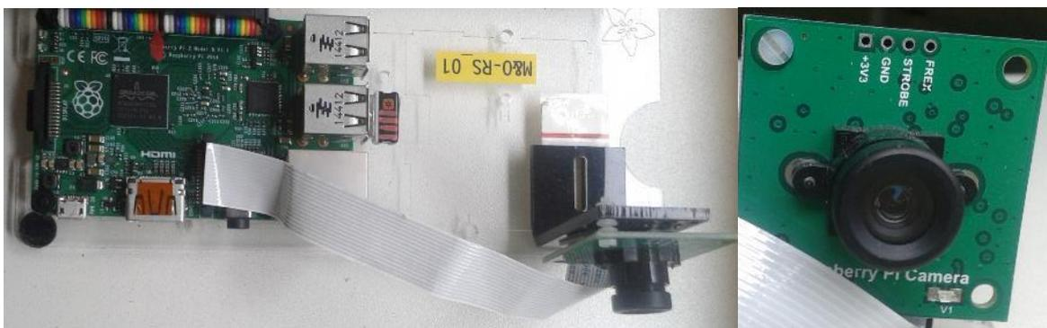
Abbildung 1: Links: Pi + Kameramodul, Rechts: Kameramodul (Quelle: AgriCareerNet\_2016)
